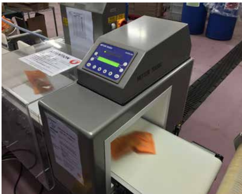
Na linijah nameščene ključne nadzorne točke (CCP) preverjajo vse pakete za vsebnost kovin, da se zagotovi varnost izdelka skladno s smernicami IFS.
