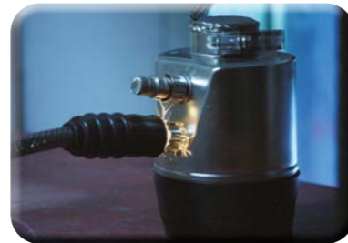
POWERCELL® PDX® Wägezellen halten Blitzschlägen von bis zu 80 000 A in voneinander unabhängigen Laborprüfungen (IEC-Standards 62305-1) stand.
