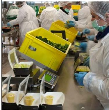
Die ICS-Produktfamilie steht für schnelle und effiziente Portionierungs- und Klassifizierungsverfahren. Abhängig von der bevorzugten Arbeitsweise hat der Bediener die Wahl zwischen verschiedenen Betriebsarten. Ob zum Befüllen von Behältern auf der Waage oder zur Nutzung des leistungsstarken Take-away Modus zum Portionieren – es müssen keine Tasten betätigt werden, sodass die ICS-Waagen für eine Produktivitätssteigerung von bis zu 20 % sorgen.
