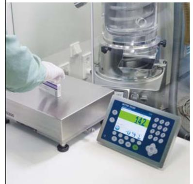
Wenn es um Produktintegrität geht, ist das Kontrollwägen eine schnelle und kosteneffektive Methode zur Qualitätssicherung. Ob es darum geht, fehlende Teile von Baugruppen oder ganzen Sendungen zu ermitteln, die Gussteile auf Vollständigkeit zu überprüfen oder um die verwendete Schmiermittelmenge zu kontrollieren: Die ICS-Waagen informieren deutlich darüber, ob die Qualitätsvorgaben erfüllt wurden und ob die Sendung vollständig ist.
