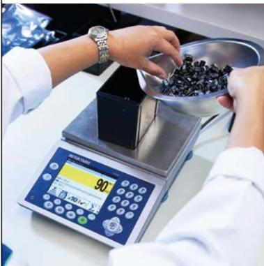
Beim Zählen von Teilen mit einem Wägesystem muss sich der Bediener normalerweise auf die Terminalanzeige konzentrieren, wodurch der Prozess verlangsamt wird. Die colorWeight® Funktion zeigt das Erreichen der Sollstückzahl anhand unterschiedlicher Farben an. Auf diese Weise wird der Bediener entlastet und der Prozess beschleunigt, sodass Sie Zeit und Geld sparen.
