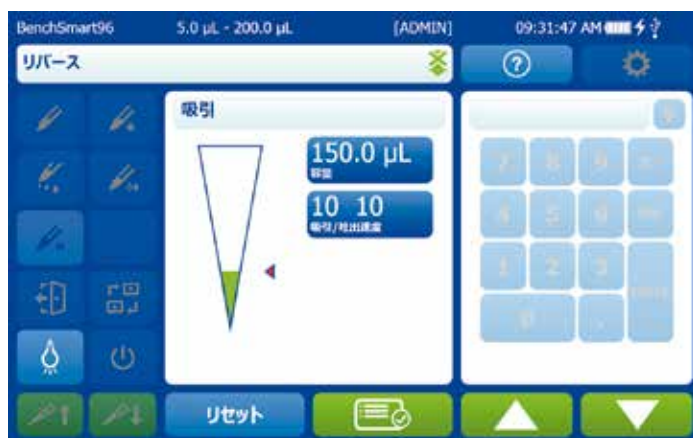
図3-43: 「ブローアウト」オプションなしのリバーズピペッティング
